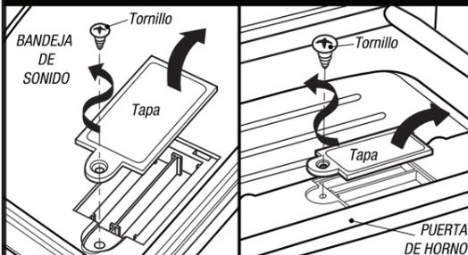
Quitar y retirar el *Tornillo* y la *Tapa* del compartimentos de las pilas. Colocar las 2 pilas respetando la polaridad y volver a colocar la *Tapa* y fijarlo con el *Tornillo*.
