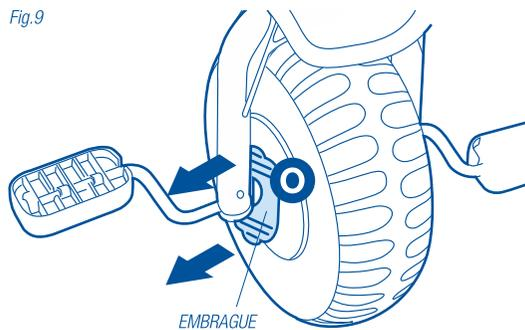
**O-** Para accionar el *Embrague*, tire hacia afuera desde la solapa del embrague, esto liberará los pedales inutilizándolos. Para volver a utilizar los pedales presione el embrague hacia adentro.
